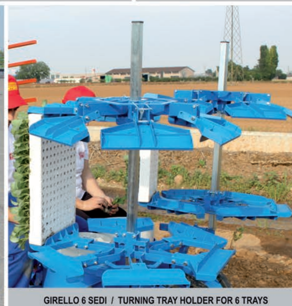
GIRELLO 6 SEDI / TURNING TRAY HOLDER FOR 6 TRAYS PORTE-PLATEAUX TOURNANT POUR 6 PLATEAUX DREHNDES KISTENGESTELL FÜR 6 KISTEN ВРАЩАЮЩИЙСЯ БЛОК ДЛЯ ЛОТКОВ ELEMENTO GIRATORIO 6 ALOJAMIENTOS
