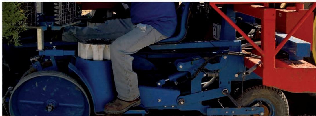
VERSIONE PARALLELOGRAMMA CON PISTONE IDRAULICO / PARALLELOGRAM VERSION WITH HYDRAULIC PISTON / VERSION PARALLELOGRAMME AVEC PISTON HYDRAULIQUE / PARALLELOGRAM AUSFÜHRUNG MIT HYDRAULISCHEM KOLBEN / ВЕРСИЯ ПАРАЛЛЕЛОГРАММ С ГИДРАВЛИЧЕСКИМ ПОРШНЕМ VERSION PARALLELOGRAMO CON PISTON HIDRAULICO
