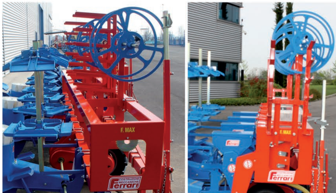
STENDIMANICHETTA CON VOMERE INTERRA MANICHETTA / WATER PIPE STRETCHING TOOL WITH PLOUGH SHARE TO EARTH WATER PIPE UP / SYSTEME POUR ETENDRE LE TUYAU DE L'EAU AVEC SOC OSCILLANT POUR ENTERRE LE TUYAU DE L'EAU / SCHLAUCHLEGEGERÄT MIT SCHLAUCHUNTERPFLUGSCHAR РАЗМАТЫВАТЕЛЬ КАПЕЛЬНОЙ ЛЕНТЫ С ЛЕМЕХОМ УКЛАДЫВАЮЩИМ КАПЕЛЬНУЮ ЛЕНТУ EXTENSOR MANGUERA Y REJA ENTIERRA MANGUERA
