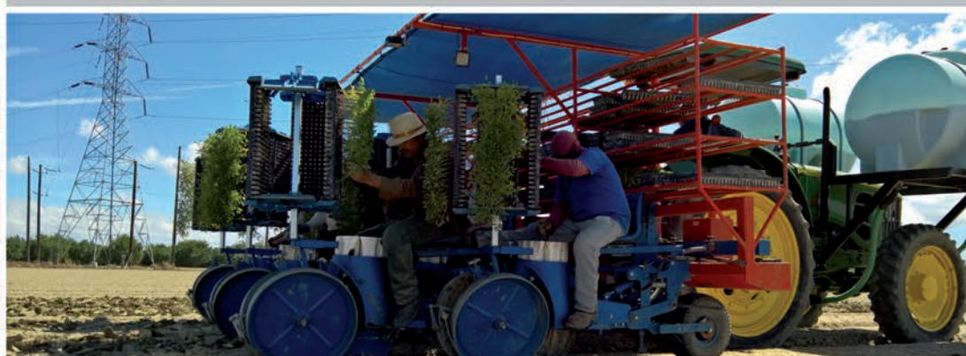
ELEMENTO ALLUNGATO PER INTERFILE MINIMA cm 35 / LONGER ELEMENT FOR ROW WIDTH MIN cm 35 ELEMENT DECALE POUR ENTRE RANGS MIN cm 35 / LANGGESTECKTES ELEMENT REIHENABSTAND MIN cm 35 УДЛИНЯЮЩИЙ ЭЛЕМЕНТ ДЛЯ МИНИМАЛЬНОГО МЕЖДУРЯДЬЯ 35 см ELEMENTO ALARGADO PARA INTER-FILA MIN cm 35
